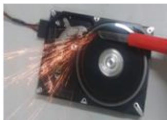
Figura 4: esmeril feito com HD. Fonte: Próprio autor (2016).
